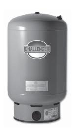
Los Tanques precargados Challenger® con tecnología de diafragma CAD2, están construidos en acero solido calibre 16. Diseñado pensando en las necesidades de los contratistas con calidad Flexcon y rendimiento a un precio competitivo. Cada tanque se somete a pruebas de costura, alta presion y helio, para detectar fugas de aire. Una prueba final de aire asegura que cada tanque llegue con una pre-carga correcta. Sus principales materiales y caracteristicas son:
